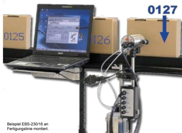
Beispiel EBS-230/16 an Fertigungslinie montiert.
